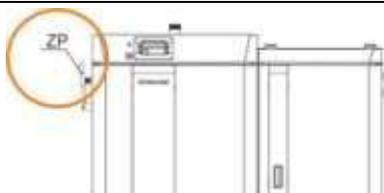
Zur Reinigung der Rauchgaszüge ziehen sie mehrmals am seitlichen Reinigungshebel (ZP).
