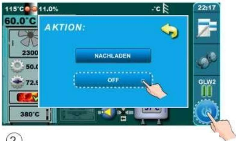
Drücken Sie das „Ein/Aus“ Symbol rechts unten. Auf dem Display erscheint ein Fenster in dem folgende Optionen angezeigt werden: "NEU LADEN" und "AUS". Drücken Sie den Knopf "AUS".
