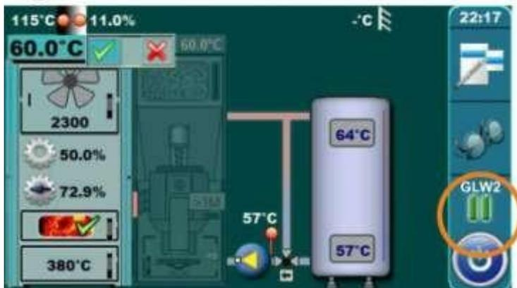
Wenn auf dem Display des Kessels die Betriebsphase "GLW2" angezeigt wird, bedeutet das, dass der Kessel das ganze Holz verbraucht hat und es ist nur noch Glut vorhanden
