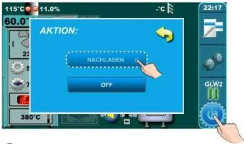
Drücken Sie das „Ein/Aus“ Symbol rechts unten. Auf dem Display erscheint ein Fenster in dem folgende Optionen angezeigt werden: "NEU LADEN" und "AUS". Drücken Sie den Knopf "NEU LADEN".
