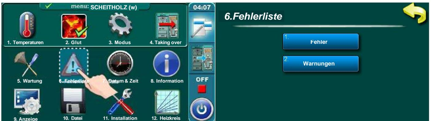
Wenn das Symbol „Fehlerliste“ gedrückt wird, öffnet sich das Fenster „6.Fehlerliste“. In diesem Fenster kann zwischen den Optionen „Fehler“ und „Warnungen“ gewählt werden. Die „Informationen“ werden in der Liste „Fehler“ mit angezeigt.
